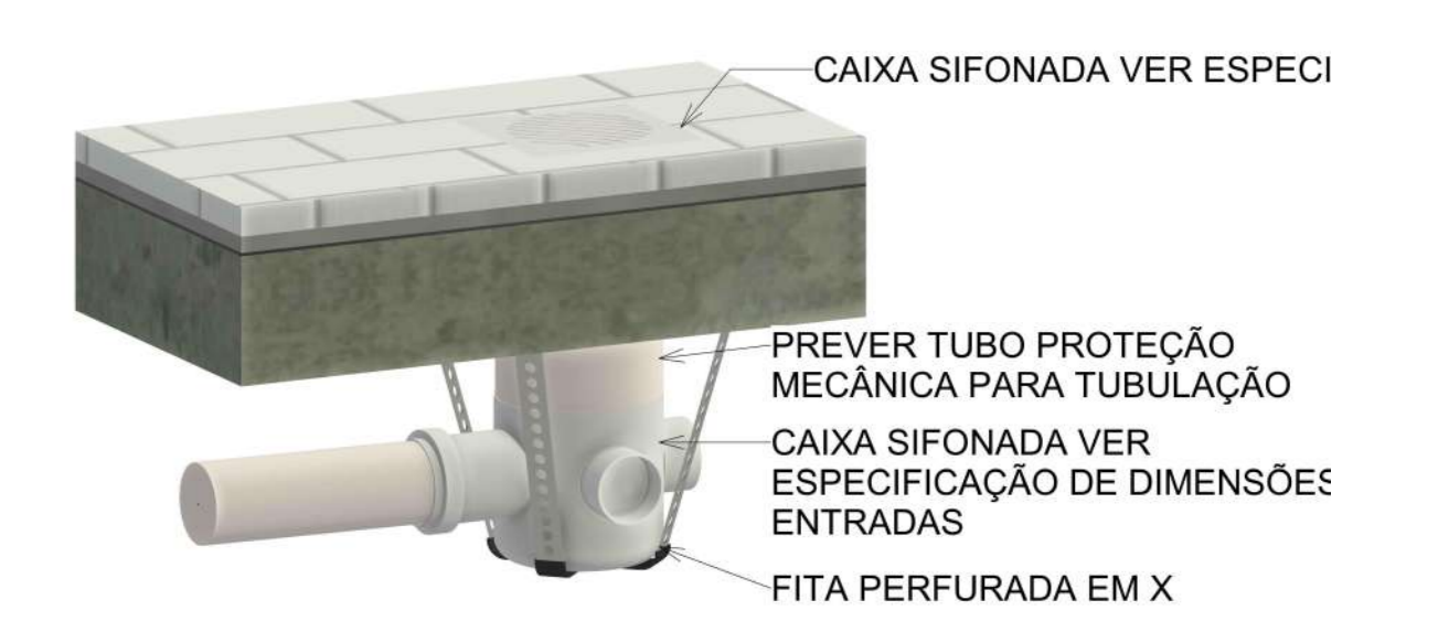
Detalhe Suporte Caixa Sifonada
