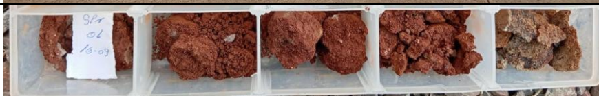
Foto 3.6 – Amostras de solo obtidas no furo SPT-01.
