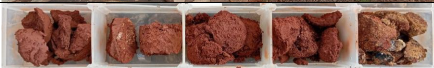
Foto 3.4 – Amostras de solo obtidas no furo SPT-01.
