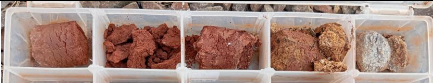
Foto 3.2 – Amostras de solo obtidas no furo SPT-01.
